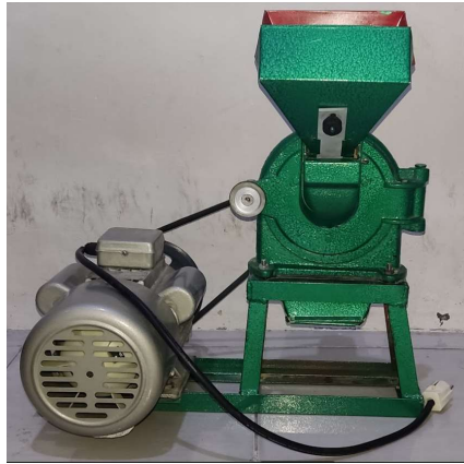
Gambar 3. Mesin penepung bumbu Sumber: Dok. Pengabdian, 2022.
